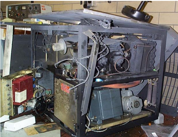
Foto 1: zerstörte Laborzentrifuge (Quelle: www.aiha.org )
