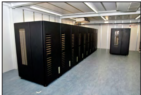
Bild 1: Blick ins Innere der neu installierten Sicherheitszelle mit dem Bandkassettenroboter. Foto: Benjamin Bollendorff
