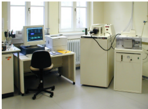
Abb. 16 Finnigan TSQ700 im Sommer 2000 in INF271, R007. Auf dem Bild ist die EI/CI-Quelle angesetzt, die ESI-Quelle ist unter der Abdeckung rechts auf der ESI-Versorgungseinheit untergebracht.
