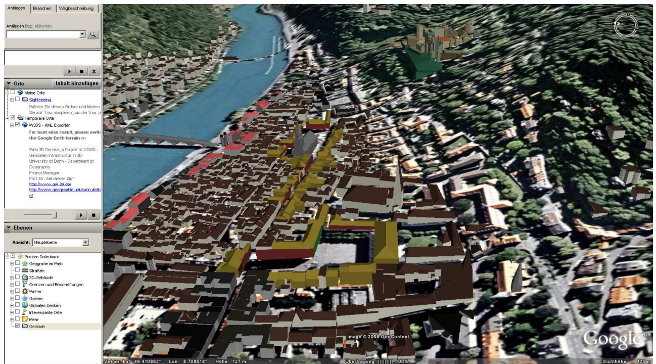
Abb.5: Vom W3DS von GDI-3D als KML ausgegebenes LOD2 Stadtmodell von Heidelberg in Google Earth mit dort zu ungenauem DGM (Gebäude versinken oder schweben)
