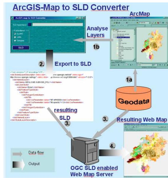
**Abb 1.** Prozessdiagramm: Design einer Karte in ArcMap, Export derselben in ein SLD Document. Dieses kann genutzt werden, um WMS Server zu konfigurieren oder Nutzerspezifische Darstellungsanfragen per SLD an SLD-WMS zu senden.
