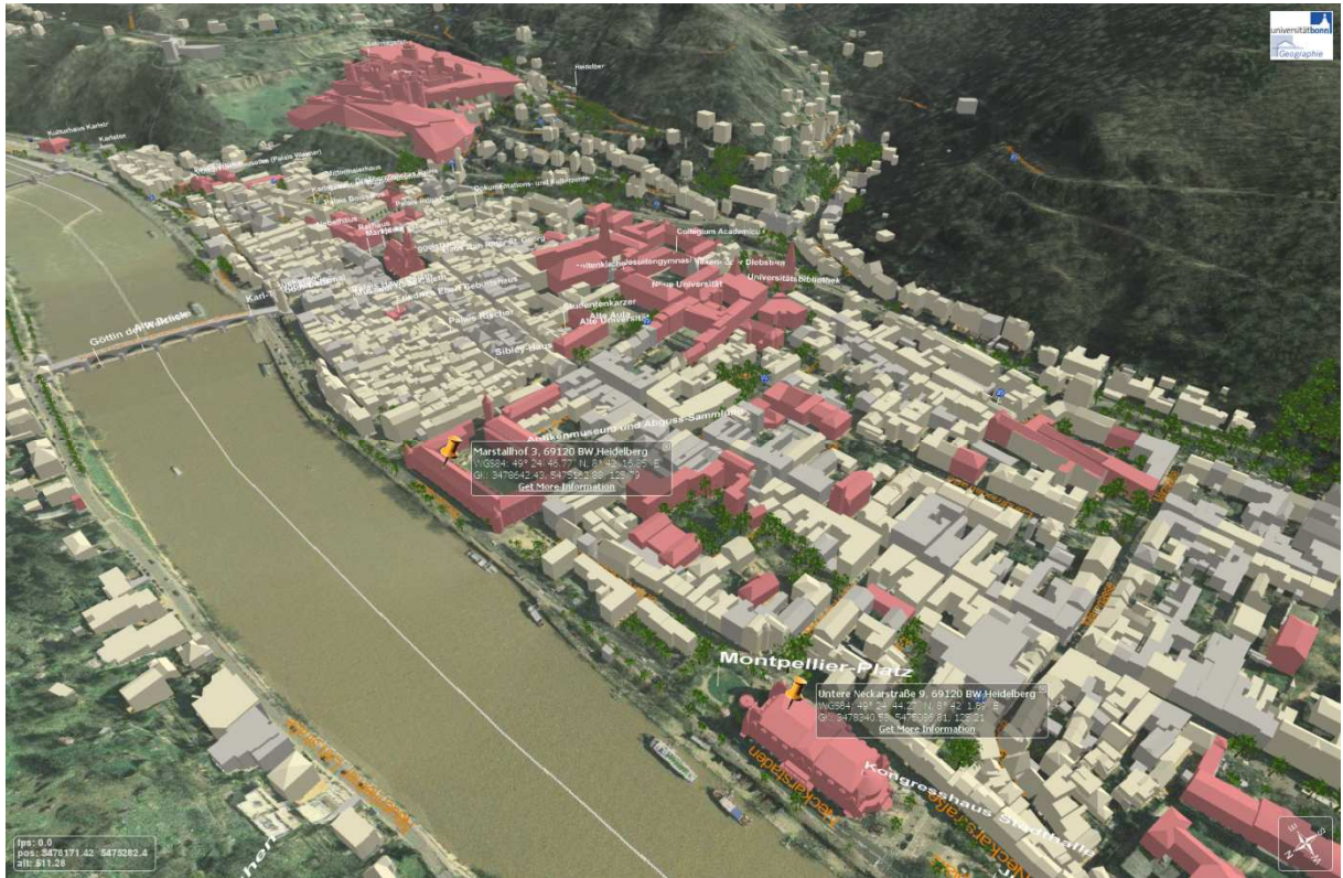
Per SLD-3D und Filter-Encoding dynamisch erzeugte thematische Ansicht von Heidelberg-3D im Client: Gebäude eingefärbt nach Nutzungsart (öffentlich, gemischt, privat), kombiniert mit 10cm Luftbild auf 5Meter DGM und kombiniert mit weiteren Informationen.
